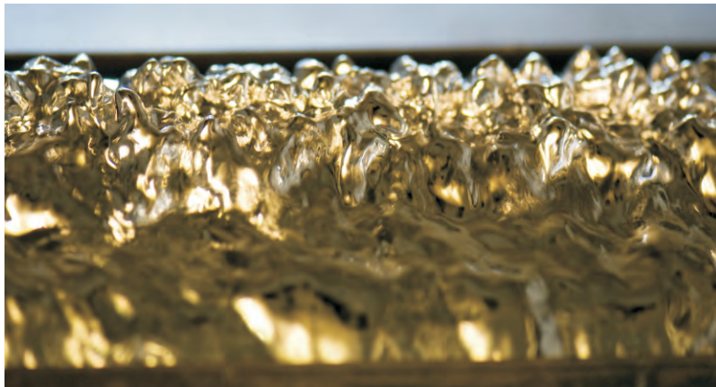
Zinnbad einer Wellenlötanlage.
