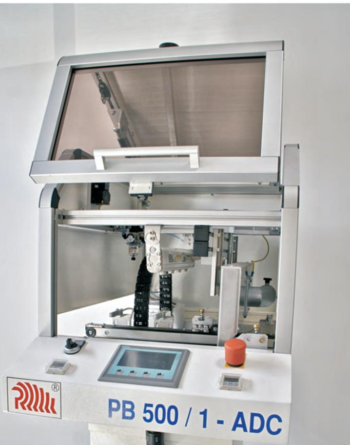
Mit ADC erreichen Elektronikhersteller die berührungslose, zuverlässige Reinigung von Leiterplatten direkt in der Zuführung zum Lotpastendruck.
